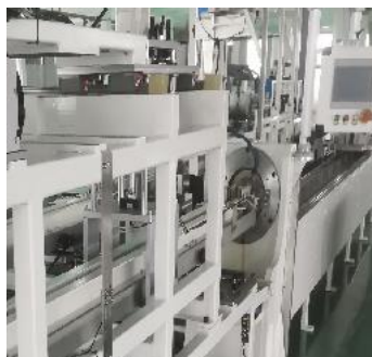
Obrázok č.38: Proces ťahania za studena na stroji na ťahanie za studena
