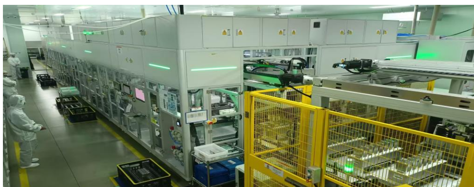
Obrázok č.18: Sekundárna injekcia elektrolytu
