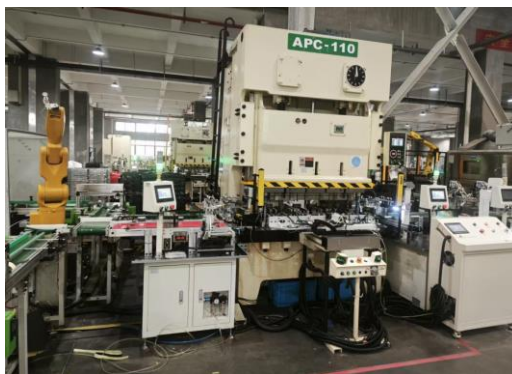
Obrázok č.42: Proces dierovania automatického dierovacieho stroja
