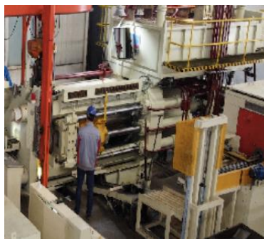
Obrázok č.36: Proces vytlačania za tepla v integrovanom stroji na vytlačanie za tepla a sušenie
