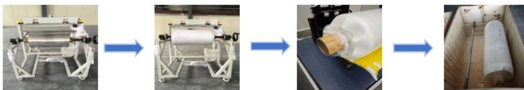
Obrázok č.29: Obalové materiály sa používajú najmä na utesnenie zvitku hliníkovej fólie potiahnutej uhlíkom a na zaistenie bezpečnosti počas prepravy a skladovania, aby sa zabránilo poškodeniu a znehodnoteniu výrobkov z hliníkovej fólie potiahnutej uhlíkom. Kontrolné body zahŕňajú najmä tesnenie a upevnenie
