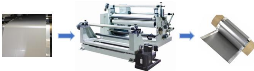
Obrázok č.28: Na prevíjanie sa používa najmä navíjačka na prevíjanie potiahnutej cievky. Hlavným účelom je odstrániť chyby v procese povrchovej úpravy a navinúť ju na požadovanú dĺžku. Kontrolné ukazovatele zahŕňajú najmä vyrovnanie okrajov a dĺžku veľkej cievky
